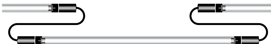
Luxsystem SL 20.1 zur Vermeidung von Dunkelstellen versetzt angeordnet und mit Luxsystem-Verbindungsleitung verbunden
