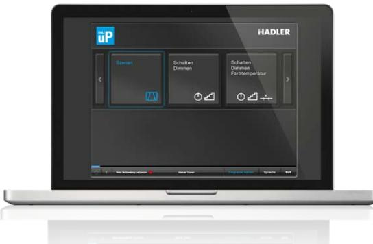
Das DALI-System mit der DALI uP-Software und einem DALI uP vollständig einrichten. Leuchten grafisch adressieren und gruppieren. Die Einrichtung des DALI-Systems über die Software testen.
