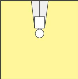
Abstrahlwinkel > 330° sorgt für Deckenaufhellung wie bei Leuchtstofflampen.
