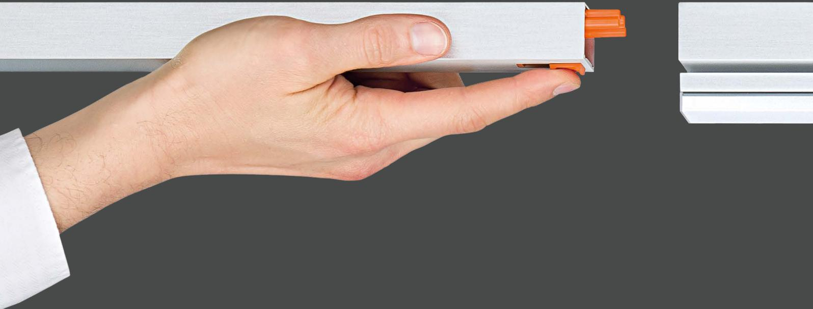
Die verschiebbare Steckvorrichtung ist kompatibel zur SL 20.3 LED Leuchtenserie, die Betätigung erfolgt durch einen in der Leuchte eingebauten Schieber. Die Busleitung ist integriert, um den Montageaufwand auf ein Minimum zu reduzieren. Die hohe Stromtragfähigkeit ermöglicht das Gestalten langer Leuchtenstränge. Robuste gedrehte Silberkontakte gewährleisten auch nach häufigem Betätigen der Steckvorrichtung sicheren Kontakt. Anschluss- und Verbindungsleitungen sind als Systemzubehör erhältlich.
