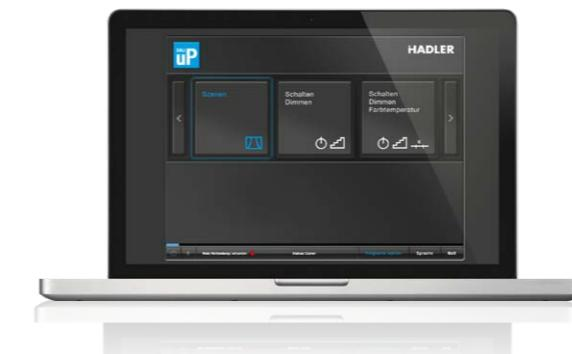
Das DALI-System mit der DALI uP-Software und einem DALI uP vollständig einrichten. Leuchten grafisch adressieren und gruppieren. Die Einrichtung des DALI-Systems über die Software testen. With the free DALI uP software its easy to configure an entire DALI system. From the software luminaires can be graphically addressed, grouped, or configuration tested.
