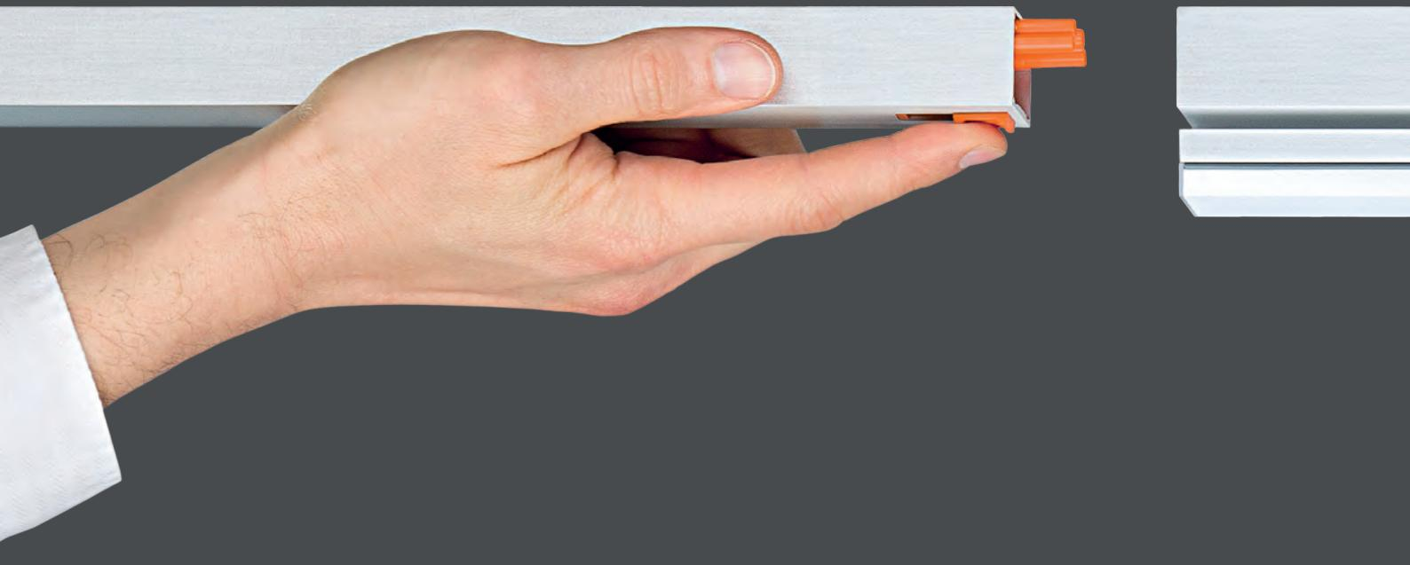
Die verschiebbare Steckvorrichtung ist kompatibel zur SL 20.3 LED Leuchtenserie, die Betätigung erfolgt durch einen in der Leuchte eingebauten Schieber. Die Busleitung ist integriert, um den Montageaufwand auf ein Minimum zu reduzieren. Die hohe Stromtragfähigkeit ermöglicht das Gestalten langer Leuchtenstränge. Robuste gedrehte Silberkontakte gewährleisten auch nach häufigem Betätigen der Steckvorrichtung sicheren Kontakt. Anschluss- und Verbindungsleitungen sind als Systemzubehör erhältlich.
